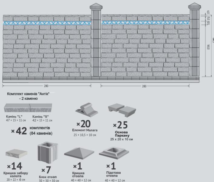
Огорожі колекції "Антик" муруються з зістарених повнотілих блоків. При цьому застосовуються бетонні блоки двох розмірів 420x150x110 та 470x150x110. Ця асиметричність блоків додає огорожі природного вигляду.
